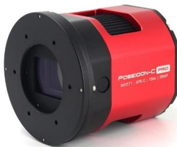
Poseidon-C Pro (IMX571) 制冷相机由头号玩家开发，专为高端深空摄影而设计。采用索尼 IMX571 APS-C 画幅彩色传感器。3.76um 像素大小，以及 71.7Ke 满阱，总像素数 2600 万（分辨率 6252\*4176），对角线 28.3mm。
