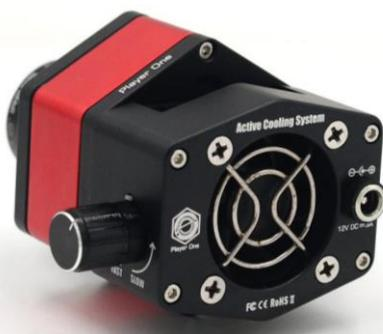
Saturn SQR 相机非常适合月球和行星摄影。1 英寸的画幅加上 900 万像素的分辨率，可以更轻松的拍摄太阳和月球圆面细节，而且进行马赛克拼接也更高效。
