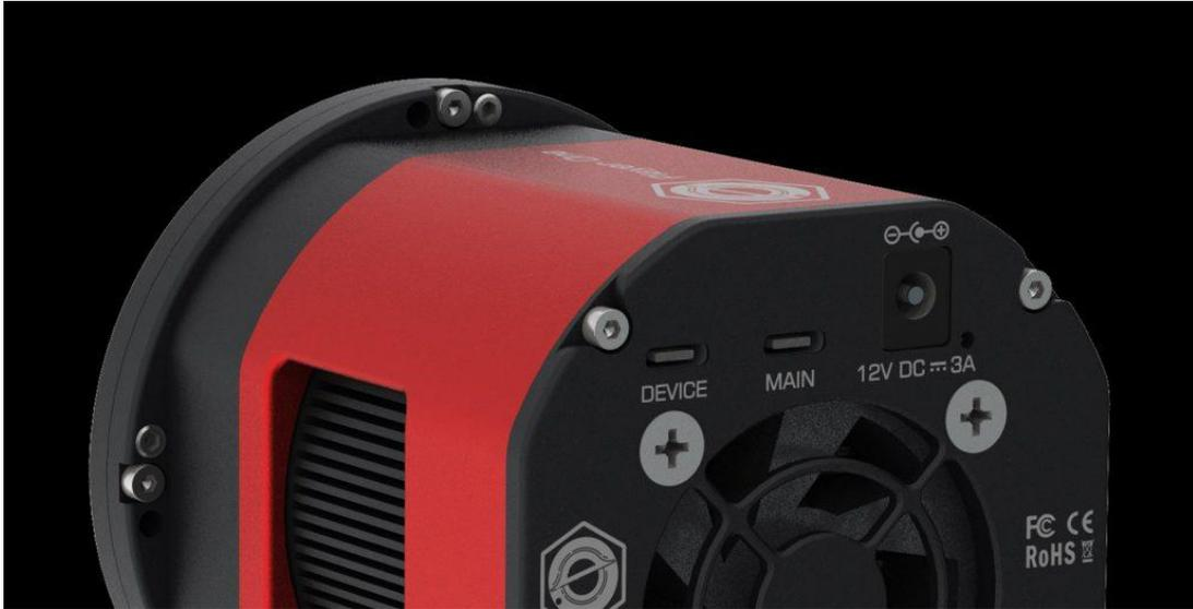
主数据口支持 USB3.0 协议，相机在 RAW8 模式下可以达到 6.5fps。夜间组装设备时，Type-C 接口支持双面拔插，所以更容易连接。
