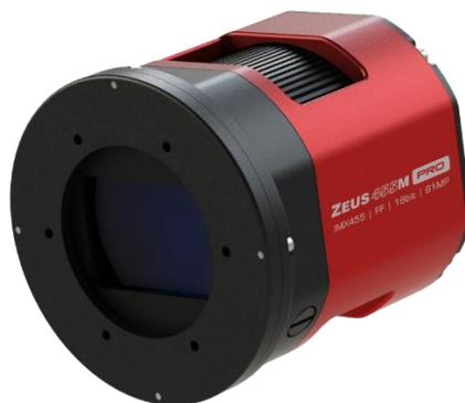
ZEUS 455M Pro 制冷相机是由头号玩研发的全画幅制冷相机，为专业的深空摄影而设计。采用索尼工业级 IMX455ALK-K 全画幅黑白传感器。3.76um 像素尺寸以及 71.6Ke 的阱深，总共 6100 万像素（分辨率为 9576\*6388），对角线为 43.3mm。
